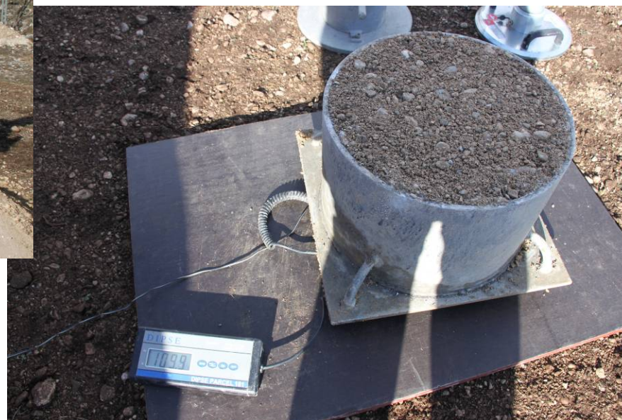
2. Dichtemessung mit Testvolumen
