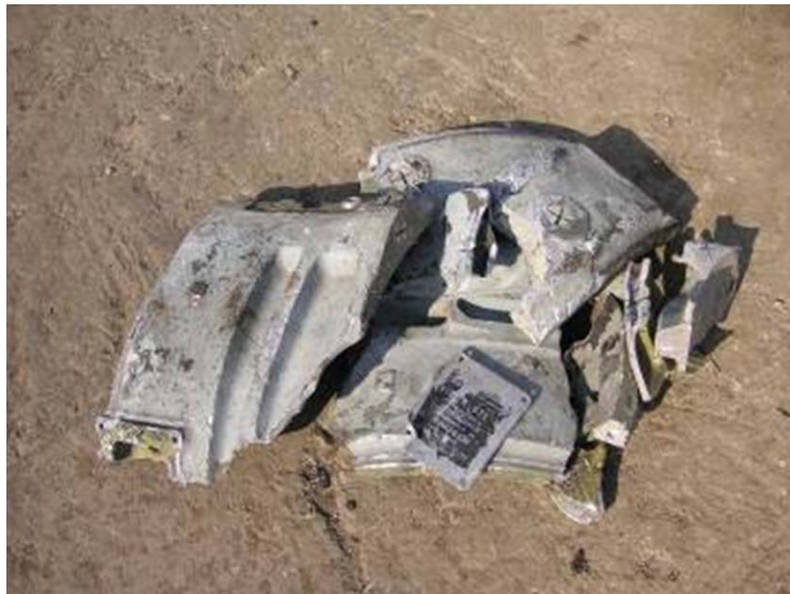
Jetturbinengehäuse Th-232, ca. 4,5 MBq
