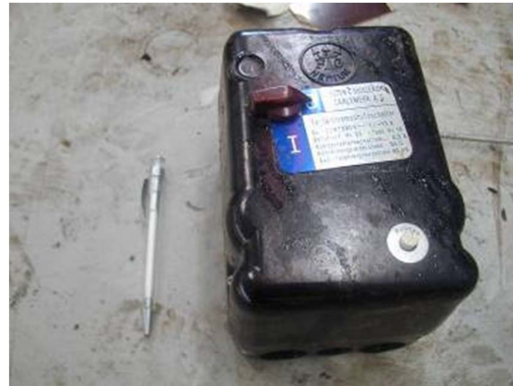
Überspannungsableiter Ra-226, ca. 1 MBq
