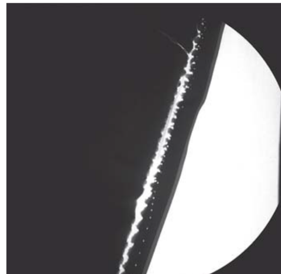
Beginnende Nahtrisse an Stellen hoher Zugbelastung
