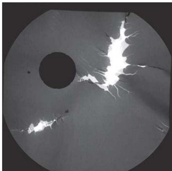
Mehre Flächendefekte in 2 Jahre getragener Schürze; Größenvergleich: 20 Cent-Münze
