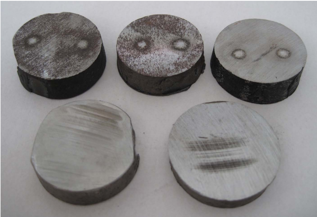
Abb. 22: Prüfkörper – Überwachung des Warenausgangs bei der Stahlherstellung.
